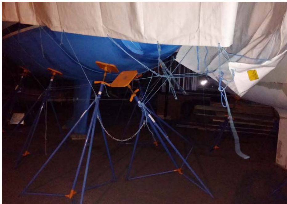
Exempel på segelbåt Bavaria 38 med masten på stöttad enligt instruktionerna
