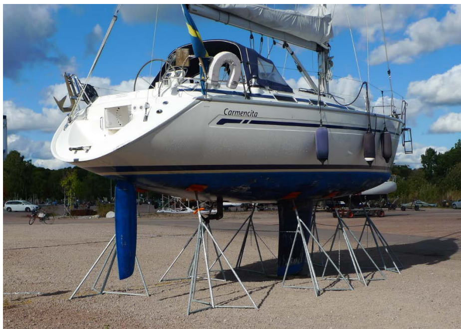
Exempel på segelbåt Bavaria 38 med masten på stöttad enligt instruktionerna
